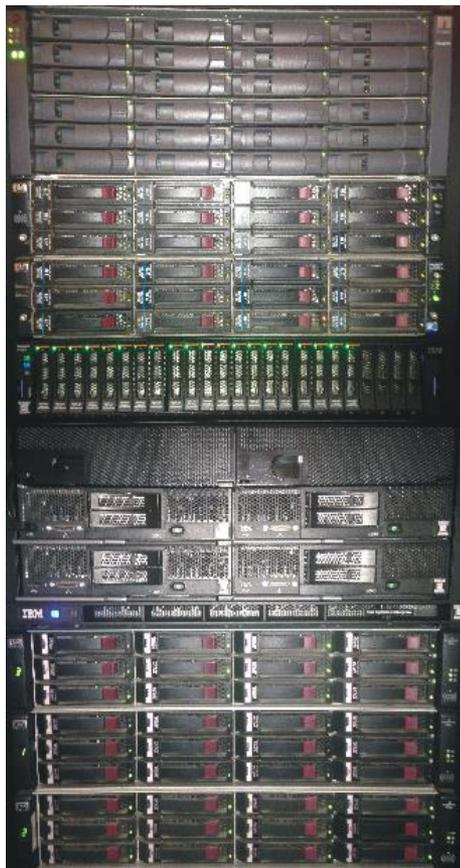
✓ В состав вычислительного комплекса входят два распределенных серверных кластера в катастрофоустойчивом исполнении, в состав которых входят **12** высокопроизводительных ультракомпактных (блэйд) серверов, комплексы систем хранения данных, сетевая инфраструктура
